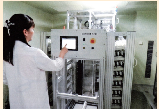
自動測定機で測定しBODを算出
